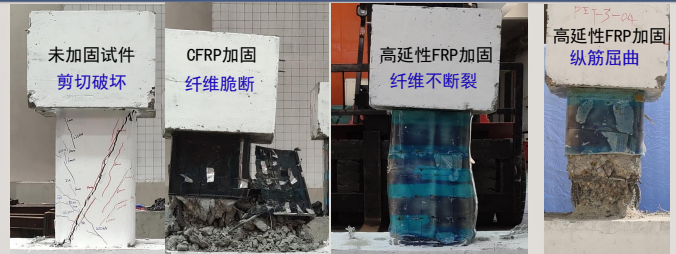
高延性FRP加固RC柱的抗震性能
