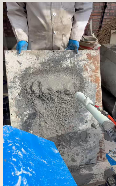
实验室混凝土喷射
