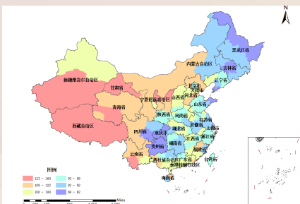
水冷型PV/T组件全国年均制热功率
