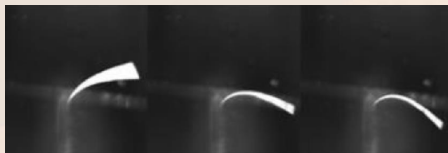
电子设备散热通道中扰动传热
