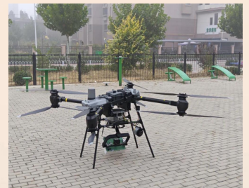
无人机SAR雷达探漏设备
