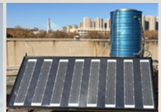
平板型热管式太阳能PVT供热系统
