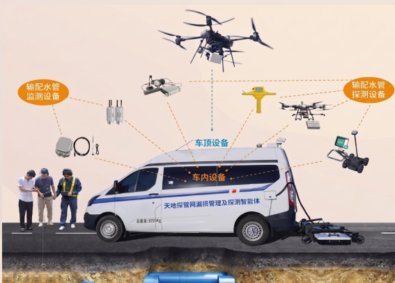
天地一体化管线漏损探测装置
