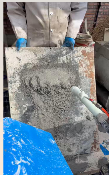
实验室混凝土喷射
