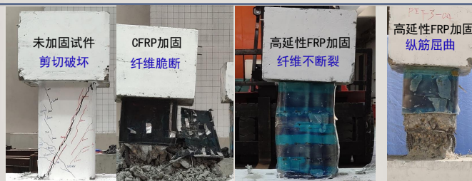
高延性FRP加固RC柱的抗震性能
