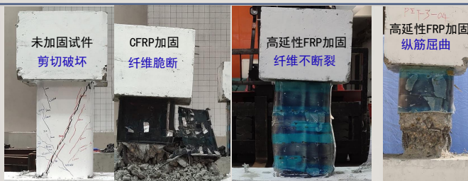
高延性FRP加固RC柱的抗震性能
