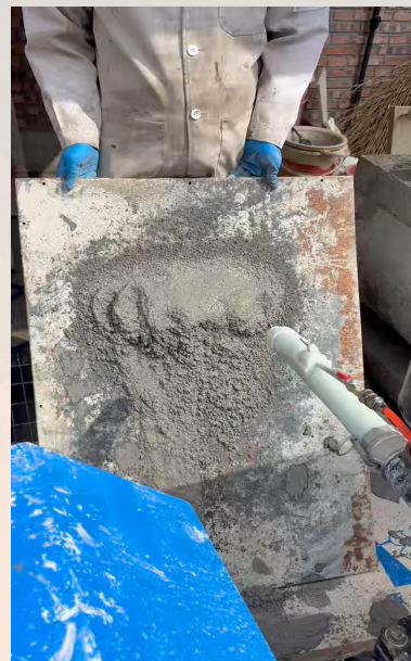
实验室混凝土喷射
